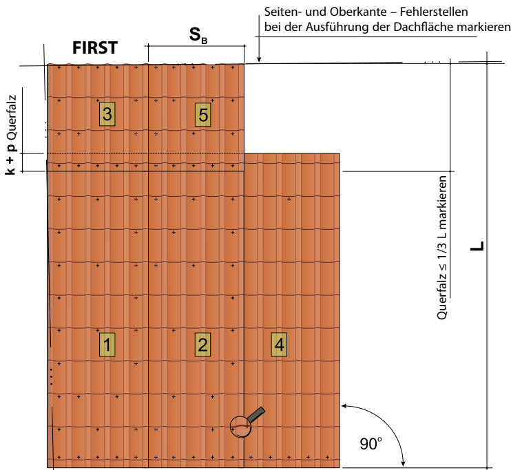
TRAUFE - Montagebasis für Dachbleche 1,2,3,4,5 - Reihenfolge der Verlegung der Blechtafeln
